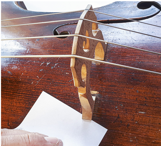
För att undvika biljud är det viktigt att stallet är noga inpassat och ligger väl an mot locket. På bilden konstateras glapp mellan stallfoten och locket med hjälp av en papperslapp.
